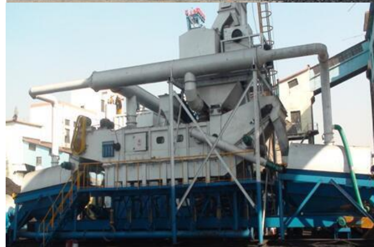
模块式干法重介质流化床选煤系统 (2013年世界首次于神华新疆建成)
