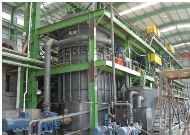
柿竹园2000吨选矿厂矿用微泡浮选柱 钨粗选系统
