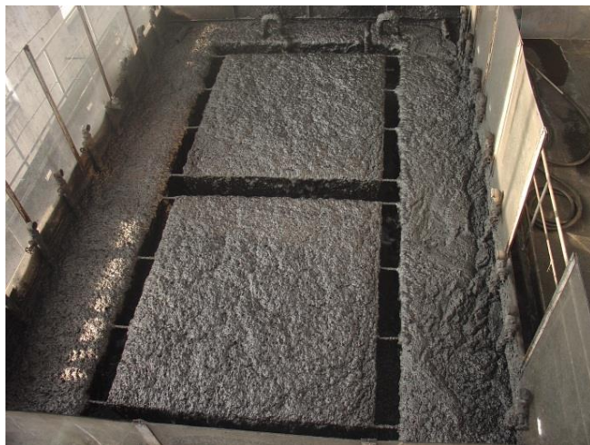
旋流-静态微泡浮选床工业系统 (峰峰孙庄选煤厂)
